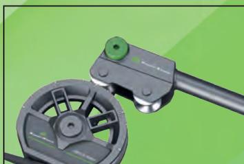
Crochet de fixation pour bloquer le tube
