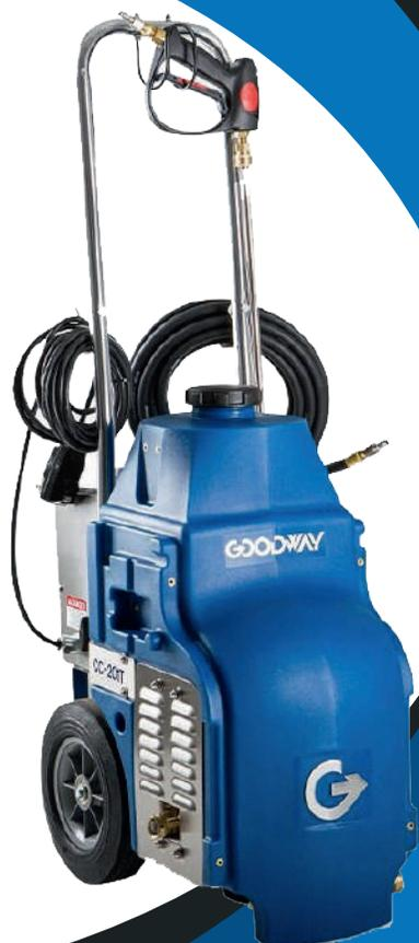
Le CC-201T est un nettoyeur portable conçue pour entretenir efficacement les serpentins des systèmes de climatisation. Il combine un système d'eau sous pression de 13,7 BAR, un réservoir intégré de 30 litres, et un nettoyant en comprimés exclusif CoilShine-T pour éliminer saleté et débris tout en inhibant la prolifération biologique. Léger et facile à utiliser, il remplace les nettoyeurs encombrants par une solution compacte et performante adaptée aux professionnels.
